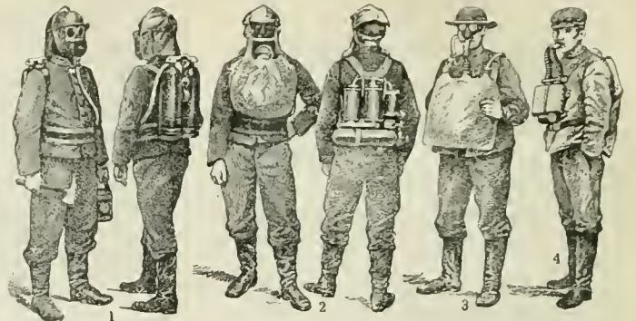
APPAREILS DE SAUVETAGE : 1. Appareil Vanginot, à compression; 2. Appareil Guglielminetti, à régénération; 3. Appareil Giersberg, à régénération; 4. Pneumatogène Jaubert.
