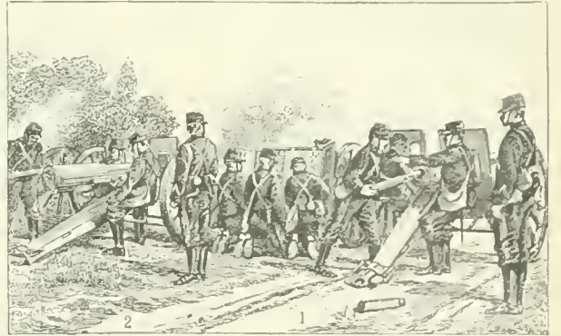
Manœuvre du canon de 75 millimètres : 1. Chargement; 2. Recul de la pièce.
