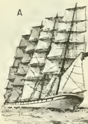
Quatre-mâts : A, quatre-mâts carré; B, quatre-mâts-goélette; C, quatre-mâts-barque.
